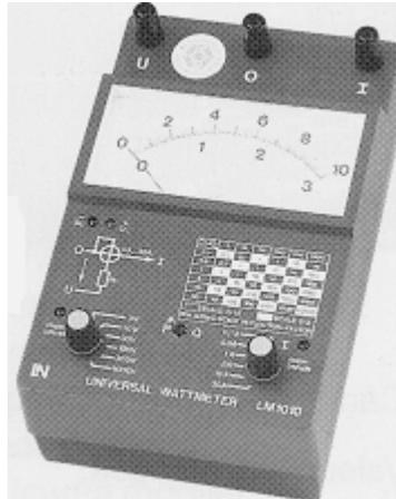
Cet appareil est particulier, il est capable de mesurer la puissance active. La formule de la puissance nous dit que  $P = U * I$ . Nous avons donc besoin de l'image du courant mais aussi de l'image de la tension.
